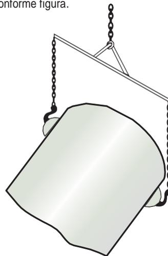
Para os tanques verticais com capacidade a partir de 3.000 litros, utilize as alças de içamento fixadas próximas ao tampo para fazer a movimentação. Estas alças são próprias para o içamento e em números de duas, a cada 180°. Sempre utilize as duas alças para movimentar o tanque. Nunca ice-o somente por uma alça. Figura
